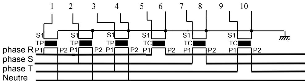
**Remarque :** bien respecter les sens de branchement : à P1 correspond S1 et à P2 correspond S2. Il est recommandé de câbler le secondaire S2 des TC à la terre.
