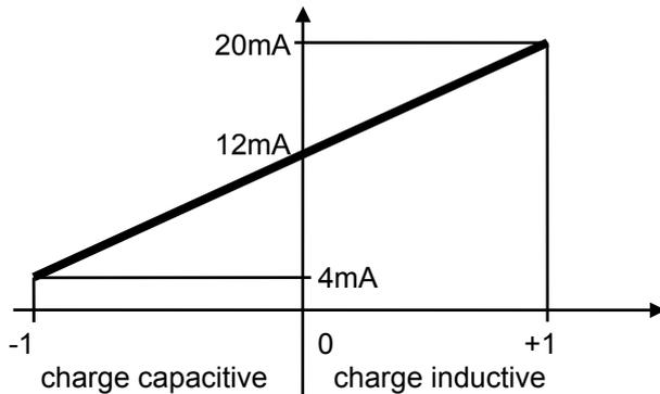
Le cosinus oscillant autour de +/-1, la sortie courant fait des bonds de 4 à 20mA. L'utilisation d'un vumètre est impossible, mais la fonction de transfert linéaire permet l'utilisation d'un indicateur numérique sur la sortie courant.
