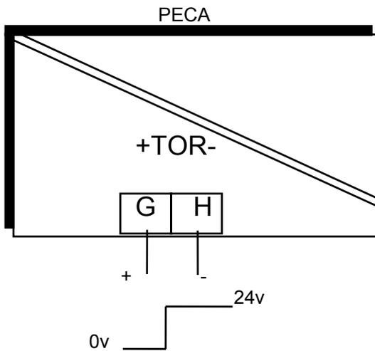
L'envoi d'une tension de 24v sur l'entrée TOR permet de valider une fonctionnalité spécifique qui a été définie lors de la commande de l'appareil, par exemple :
