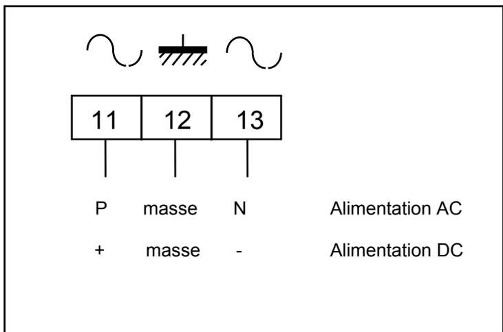
**Remarque :** Pour une alim. AC, on peut câbler indifféremment la phase et le neutre sur les bornes 11 et 13.
