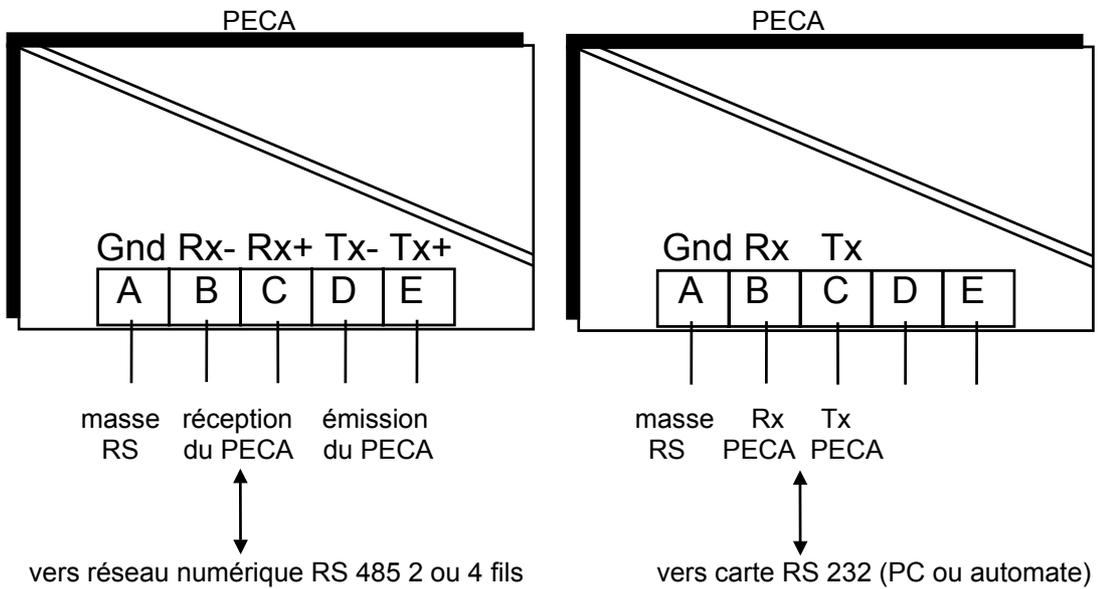
**Remarque** Sur l'appareil en fin de ligne, commuter les 2 microswitchs alignés sur ON .
