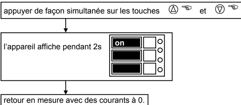
En cas d'erreur, pour revenir à la calibration par défaut , réaliser la même opération :
