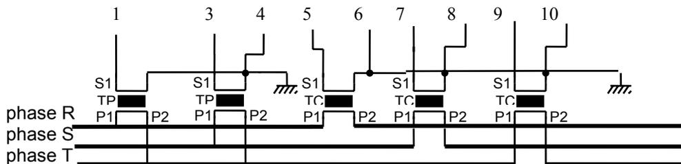
**Remarque :** bien respecter les sens de branchement : à P1 correspond S1 et à P2 correspond S2. Il est recommandé de câbler le secondaire S2 des TC à la terre.
