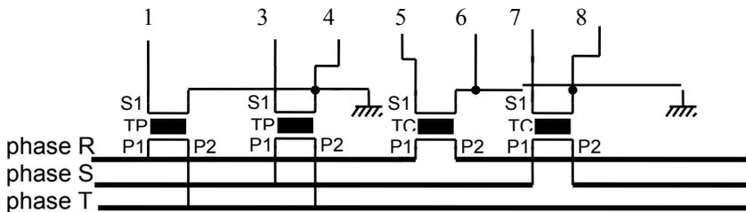
**Remarque :** bien respecter les sens de branchement : à P1 correspond S1 et à P2 correspond S2. Il est recommandé de câbler le secondaire S2 des TC à la terre.
