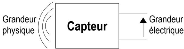
Mesurer, transformer l'amplitude d'une grandeur physique en une grandeur électrique exploitable dans un automatisme.
