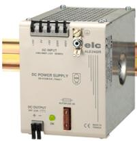
Vous avez mis en œuvre une alimentation de tension d'entrée 230 volts alternatifs et fournissant en sortie 24 volts continus (redressés filtrée) :  $230V\sim / 24 V=$ .
